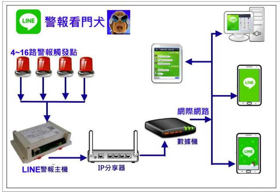
採用網路即時通報，可預先編輯訊息內容並發報給指定的 監控電腦或手機，以增進事件通報速率。安裝簡易,可 LINE APP 報警信息推送。
